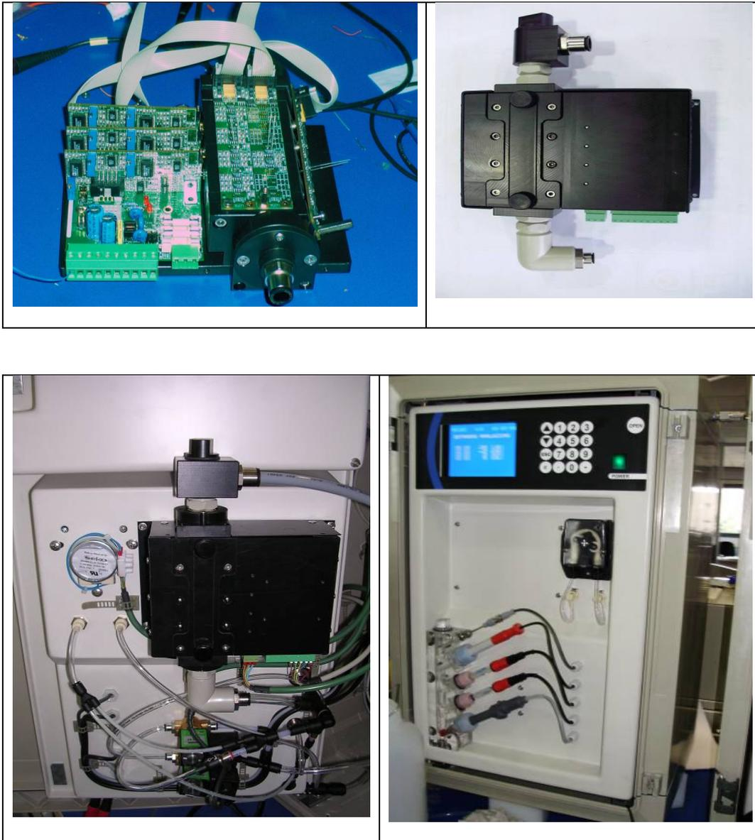
*Fig 2.- Foto 1 Interior de la Sonda mostrando la circuitería de los 4 canales, foto 2 Aspecto de la Sonda montada en su caja soporte, foto 3 La Sonda montada en el panel posterior del multiparámetro, foto 4 Aspecto del equipo multiparámetro con la medida de MO.*
